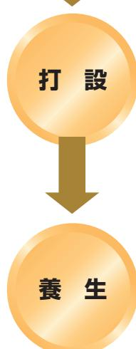
SLフロー値を確認後、モルタルポンプでNS生モルリキッド混入モルタルを施工箇所まで圧送し、部屋の隅から順に広げるように打設ます。その際レベルに合わせて土間ごで軽く均してください。打継ぎは打設から15分以内を目安としてください。
