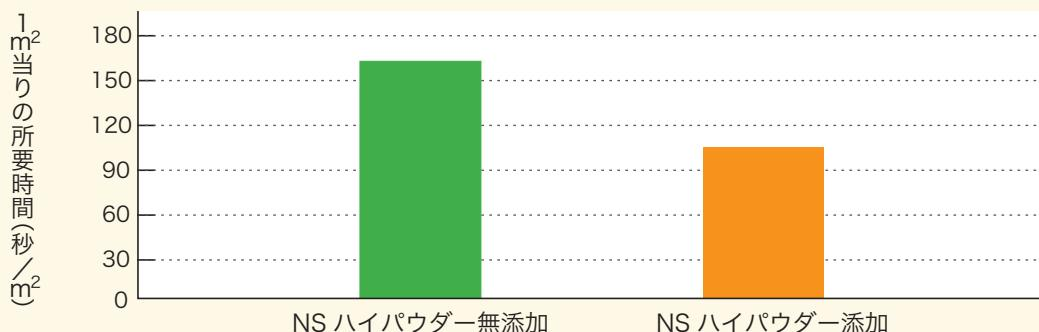
NS ハイパウダーをモルタルに混入すると、混練物は適度の柔らかさと粘りを生じて、こて伸びが一段と向上し、作業性の改良と工期の短縮に役立ちます。
