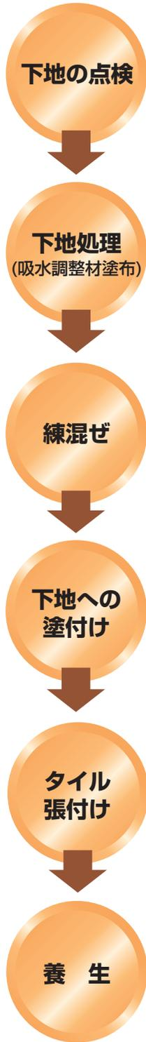
下地の浮き・割れがないことを確認し、表面の汚れ等を除去してください。浮き・割れ等は適切な処置をしてください。
